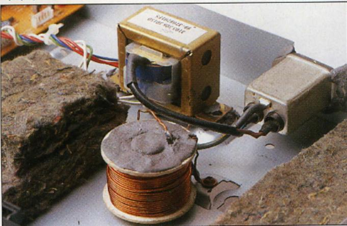
Gros plan sur le transformateur découpé, la self à noyau de 3mH et le filtre secteur optionnel.
